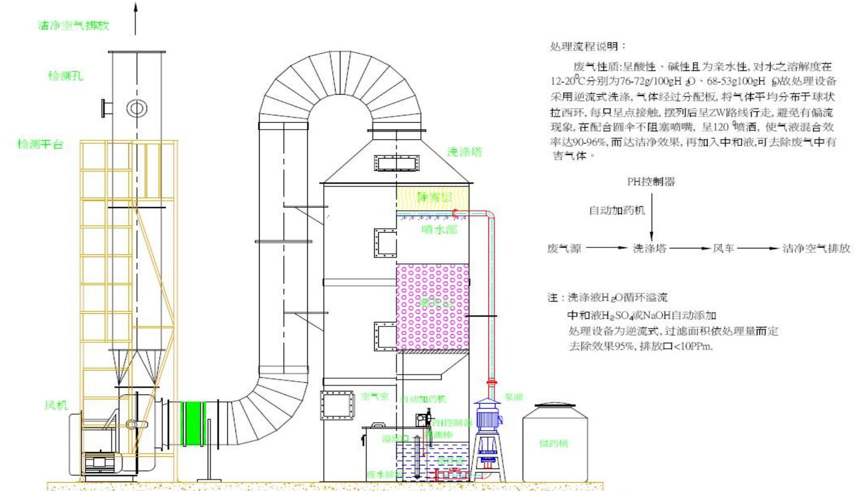
(2) 有机废气处理流程图：
